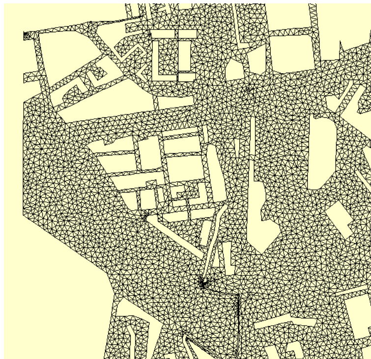
Figure 9 : Exemple de maillage avec bâtiments enlevés pour former des « îles » (pas de passage d'eau)
